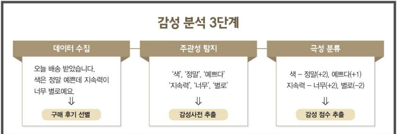
▲1단계는 데이터 수집 단계로, 웹사이트 내 해당하는 분석 자료를 수집한다. 2단계는 주관성 탐지로, 자연어로 표현된 데이터를 컴퓨터가 이해할 수 있도록 식별한다. 3단계는 극성 분류로, 해당 속성에 대한 감성 점수를 감성어 가중치 및 점수를 곱해 합산한다.
